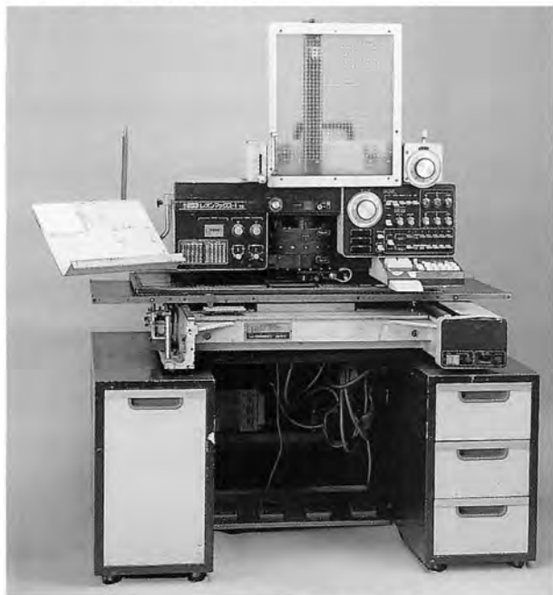
1 電子制御写真植字機 (リョービ製レオンマックス-1型YS)
