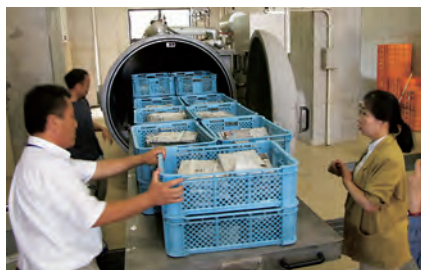
Preservation treatment (Freeze-drying of artifacts) 保存処理(資料の真空凍結乾燥処理)
