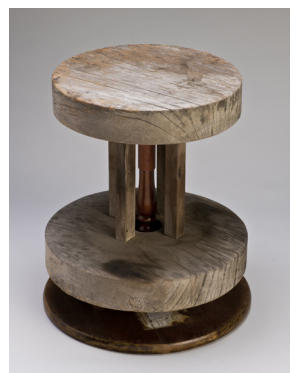
(上) 昭和50年代頃まで生産された野間焼の製作で使用された蹴りロクロ〔吉原章資料〕
