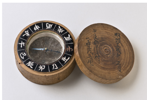
(上) 明治12年頃に10銭で購入された蓋付きの方位磁石で、十二支で方位が刻まれている。同様のものは江戸時代から明治時代初めに航海用具として使用された〔八尋シノブ資料〕
